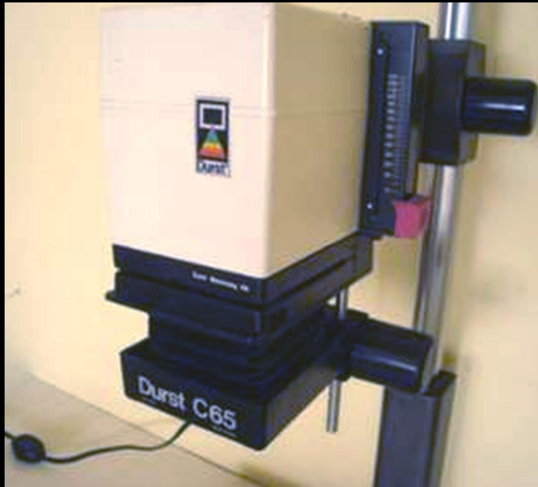
Cabeçote de ampliador a cores
